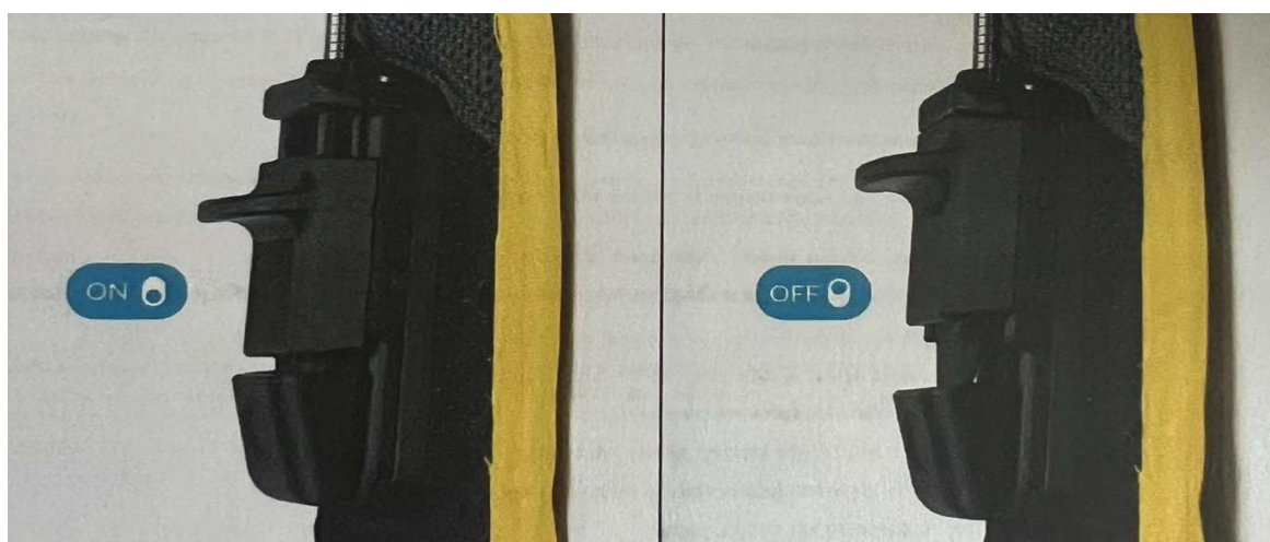
Rysunek 8. Przełącznik dwufunkcyjny zastosowany w budowie egzoskieletu wykorzystanego podczas badań autora.
