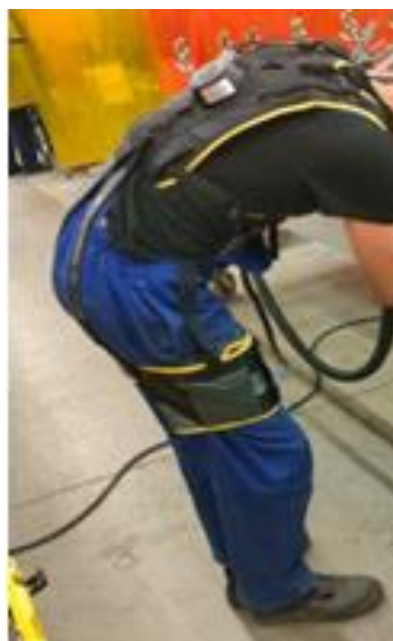
Rysunek 4. Egzoszkielet stosowany do dolnego poziomu wsparcia. Źródło: materiał własny.
